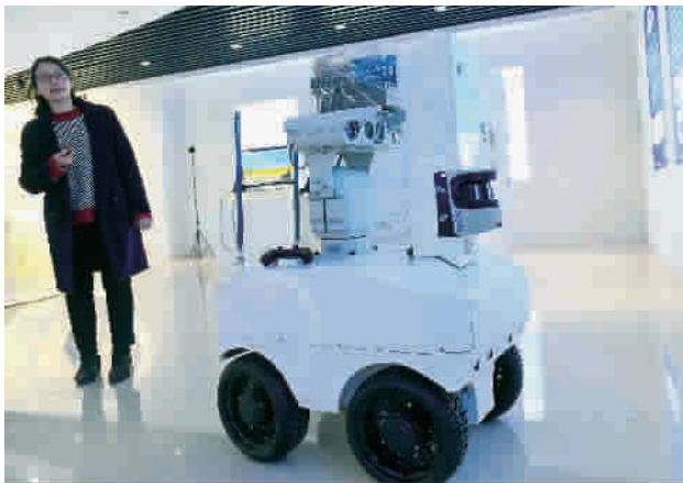
■ 变电站设备巡检智能机器人
