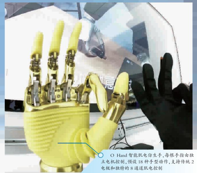
Hand智能肌电仿生手,每根手指由独立电机控制,预设18种手型动作,支持传统2电极和独特的8通道肌电控制
