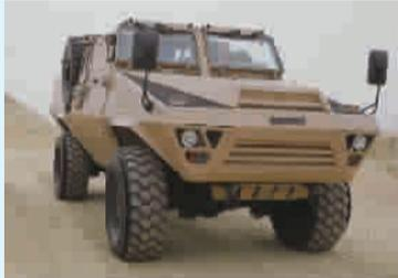
法国ACMAT公司最近披露了新型“堡垒”装甲车,该车是一种四轮驱动专用敞篷战术越野装甲车,可配装机枪、火力支援系统和自卫系统以执行近距离作战任务,具备北约标准的三级弹道防护水平和二级防地雷水平。该车在无补给条件下的巡航距离为1000千米,车底距地面0.6米,发动机功率为158千瓦,配有5速自动变速箱或6速手动变速箱,并且还配备了中央轮胎充气系统。
