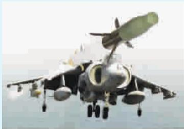
BAE系统公司于2012年1月底在美国佛罗里达州艾格林空军基地完成了“先进精确杀伤武器系统”在固定翼飞机上的首次试射。该系统是70毫米口径“海德拉”火箭弹的激光半主动制导改进型号。此次试验的载机平台是豪客比奇公司AT-6C飞机,目标距离为4.9千米。试验中,先进精确杀伤武器系统成功命中离激光指示点英寸的范围内。
