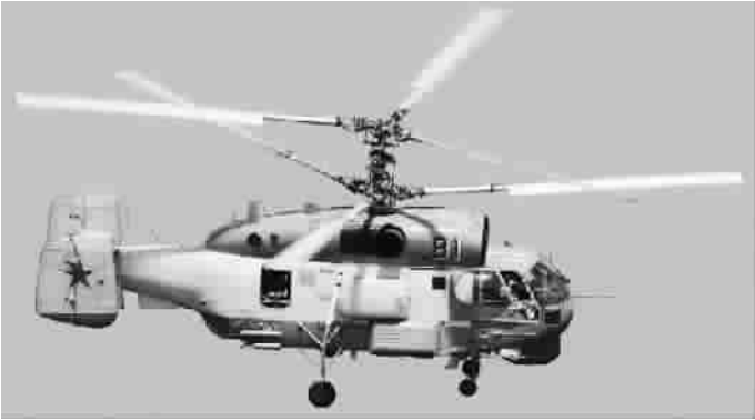
俄军装备的卡-27双发共轴式反转旋翼军用直升机(北约代号:蜗牛)
