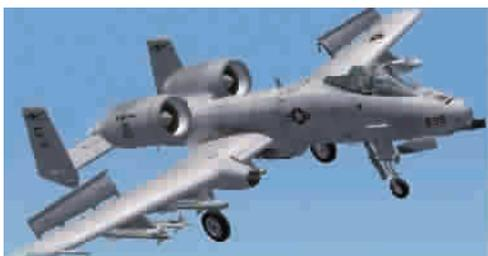
30多年前,A-10攻击机一问世就遭到美国军人的排斥,因为外形太丑,被许多人戏称为“疣猪”。该机配备2台发动机,能挂载5吨多弹药,可实施精确夜间攻击。其最突出的本领是为地面部队提供近距离空中支援,而且自身的防护性能也很了得,单人座舱下部包有装甲防护,飞行员就如同坐在“装甲澡盆”里。
