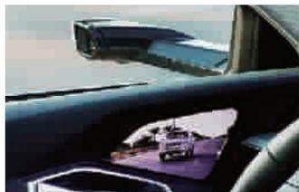
▲ 可选装虚拟外后视镜能大幅降低风阻系数,增加续航里程
