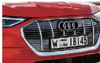
▲ 主动开闭式进气格栅可调节进气帮助降低车前风阻
